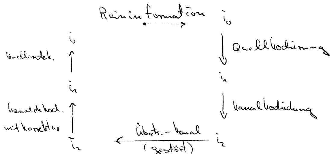
Kanalcodierung durch Blockcodes (alle Codewörter haben gleiche Länge)
