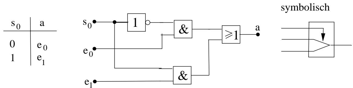
$n = 2$ : Steuersignale  $s_0 \ s_1$  Datensignale  $e_0 \dots e_3$  Ausgang  $a$
