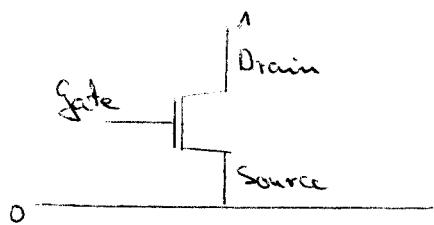
Gatespannung beeinflusst Widerstand zwischen Source und Drain
