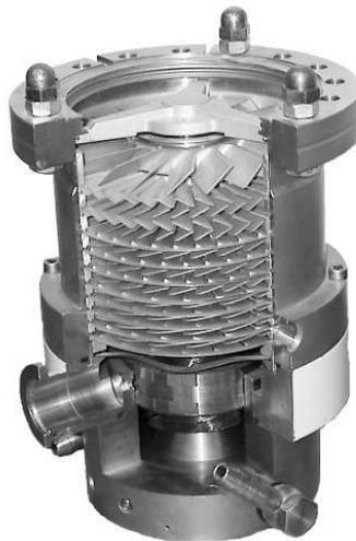
Abb. 3: Bild einer Turbomolekularpumpe
